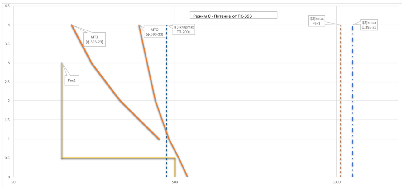
Рисунок 2 – карта селективности защит по режиму 0 – питание от ПС-393
