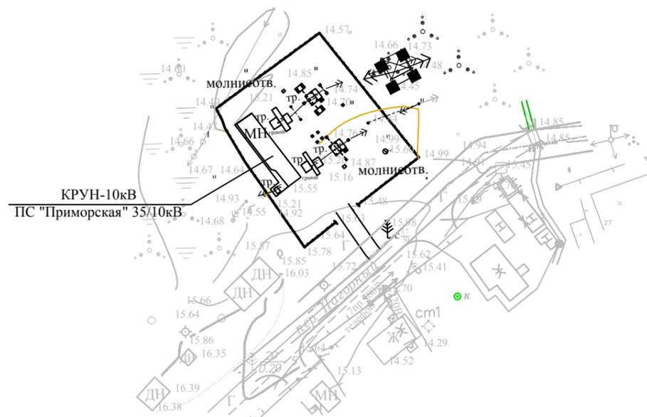
План компоновки оборудования КРУН-10кВ ПС "Приморская" 35/10кВ
